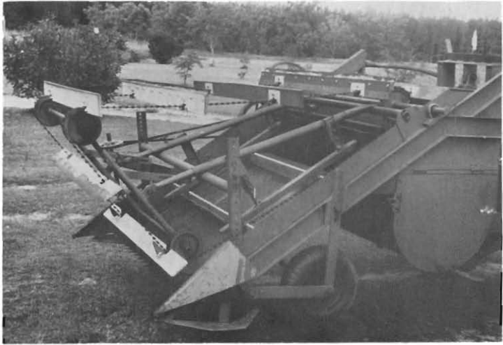
Figura 11. Cortadora empleada para cosechar la semilla de algunas gramíneas.
