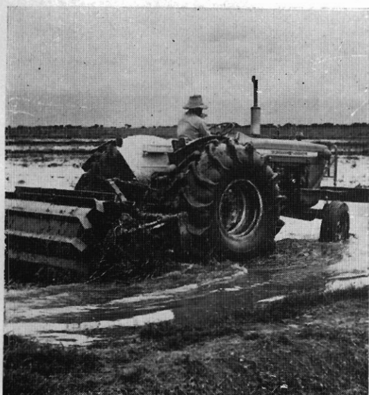
La efectividad de un cilindro accionado por un tractor que se ha diseñado para la preparación de terrenos inundados es probada en terrenos de la sede del CIAT.
