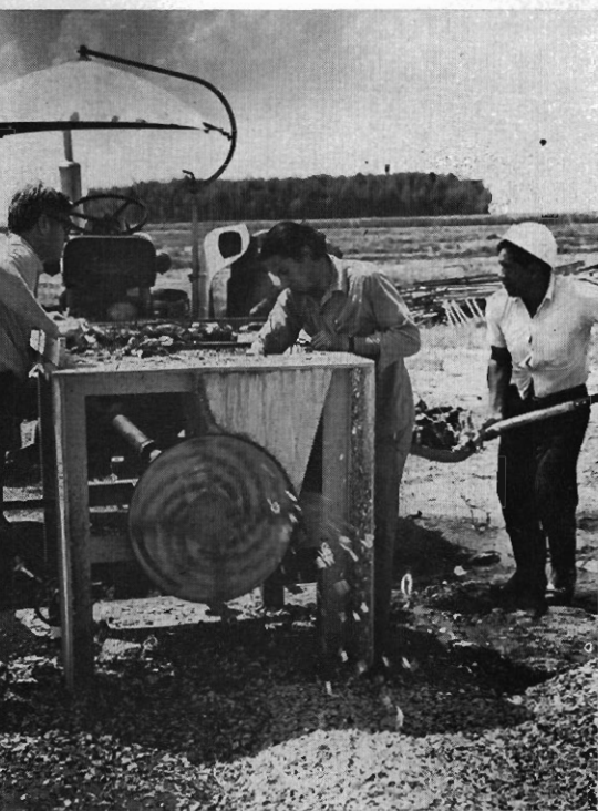
Figura 1. La desmenuzadora de raíces de yuca es accionada por el tomafuerza de un tractor.
