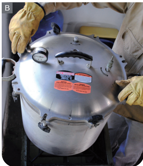
Figura 2. (A) Esterilizador eléctrico de carga frontal. Notar el uso obligatorio de implementos de seguridad al momento de manipular elementos calientes durante el cargue y descargue del equipo. (B) Detalle de un esterilizador tipo olla.
