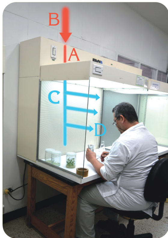
Figura 4. Detalle de cómo opera una cámara de flujo laminar. Un motor/ventilador (A) succiona aire del exterior (B) y lo fuerza a pasar a través de una unidad de filtración HEPA © para entregar aire de calidad microbiológica (esterilizado) al punto de manipulación del explante (D).
