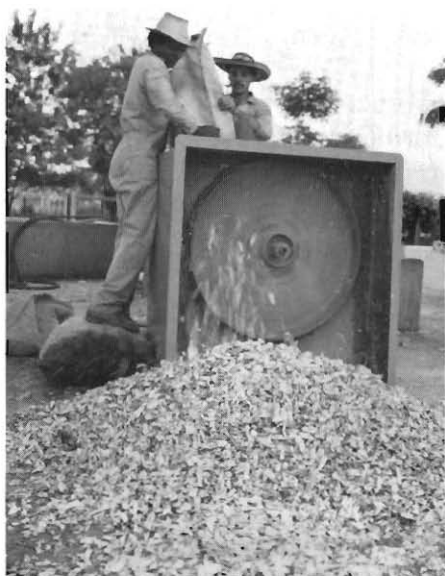
Figura 3. Mediante una máquina picadora como ésta es posible obtener trozos pequeños y uniformes de yuca.
