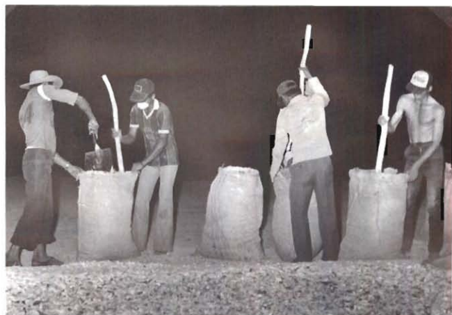
Figura 8. Apisonando los trozos secos en los sacos es posible obtener bultos de más de 50 kg.
