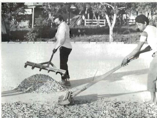
Figura 4. Esparcimiento de la yuca picada sobre el piso de secamiento con la ayuda de rastrillos de madera.
