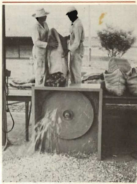
Figura 1. Para el corte de las raíces de yuca se puede utilizar un machete (a) o una máquina picadora (b).
