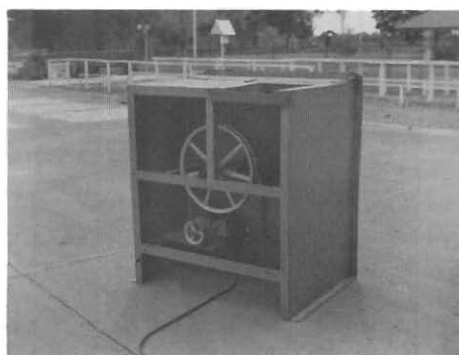
Figura 20. Máquina picadora de yuca tipo Tailandia. A = plano anterior; B = plano posterior.
