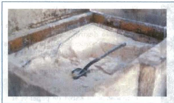
Figura 2.6. Torta de almidón en tanque de sedimentación.
