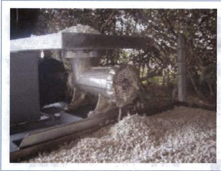
Figura 2.9. Peletizador de dextrina.
