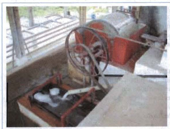
Figura 2.4. Coladora y tamiz vibratorio.
