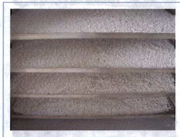
Figura 2.10. Secador de bandejas para pelets de dextrina.
