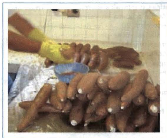
Figura 3.6. Encerado de raíces frescas.
