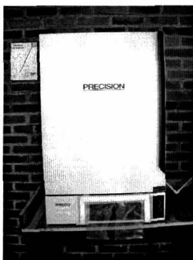
Fig. 26. Horno circulación forzada
