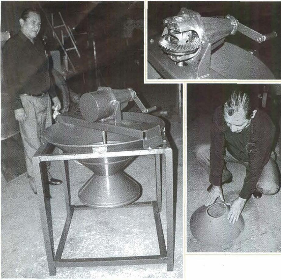
Foto 5. La descascaradora y su diseñador. Arriba, detalle de la pieza de transmisión. Abajo, el elemento de plástico que se desgasta con el uso.
