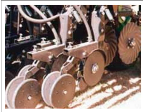
Figura 7. Tren de siembra directa, con ruedas para el control de la profundidad de siembra.
