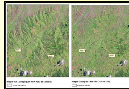
Figura 10. Análisis visual del método C-corrección. Izquierda imagen sin corrección, derecha imagen corregida.
