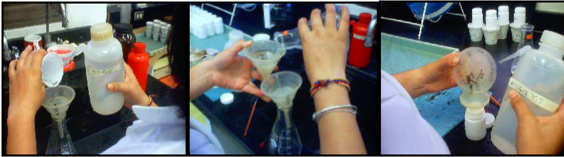
Figura 5 (A) Lavado con agua; (B) Lavado con solución salina al 35% y (C) Almacenamiento en frascos plásticos en alcohol al 70%.
