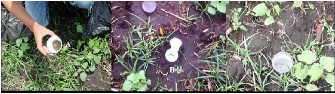
Figura 1. (A) Componente fijo de la trampa pitfall en el campo; (B) Componente móvil de la trampa y (C) Sistema de bloqueo de la trampa en campo.
