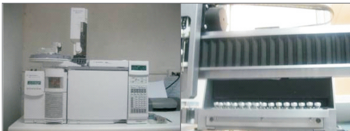
Foto 5 . Equipos de cromatografía del laboratorio Andes Control: un HPGC-MS (izq.) y un HPLC-MS/MS (der.)
