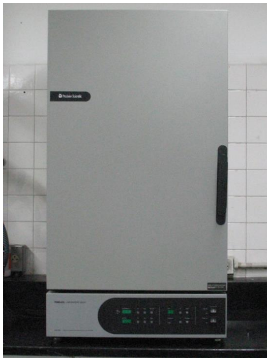
Figura 4. Horno eléctrico usado para la regeneración de la sílica gel.
