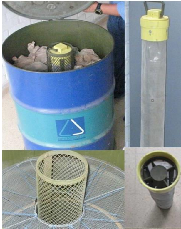
Figura 9. Dispositivo de secado de tambor de aceite, detallándose la columna central con la sílica gel.
