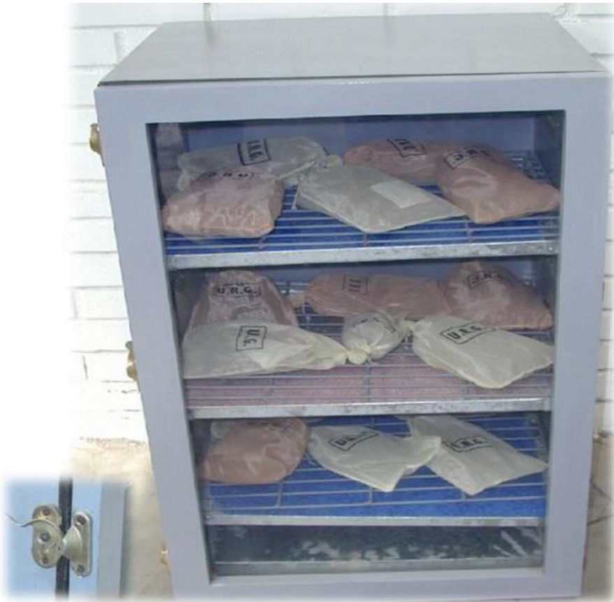
Figura 5. La cabina secadora de madera con el detalle de la cerradura.
