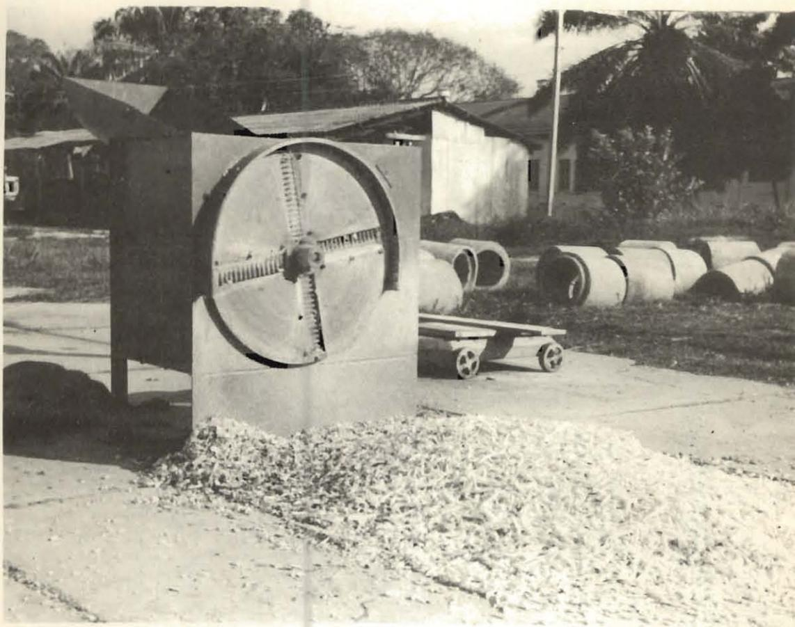
Fig. 4. Máquina picadora tipo malasio.
