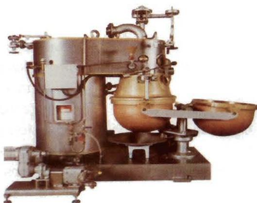
Foto 6.6. Mezcladora tipo Howard (Catálogo Comercializadora Industrial Anditec Ltda.).
