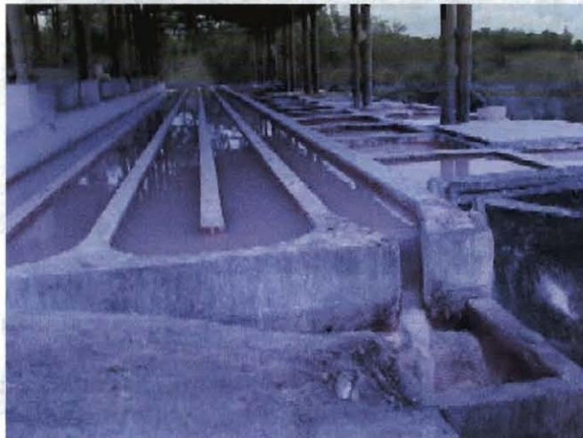
– **Recolección de la torta de almidón.** El almidón compactado en el fondo de los canales o tanques de sedimentación, presenta una humedad entre el 45-47%, es recolectado y transportado en bloques compactos hacia la etapa de mezclado del catalizador. El rendimiento del proceso varía entre 17 y 25 %, dependiendo de la eficiencia de extracción
