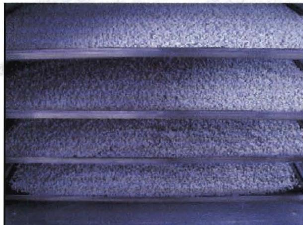
– **Enfriamiento.** Finalizada la conversión al nivel deseado, la acción del catalizador es detenida con un rápido y completo enfriamiento de la dextrina a temperatura ambiente. La dextrina puede ser humidificada hasta un nivel entre 5-12% con aire humidificado o por atomización de agua sobre ella, para evitar la formación de espuma cuando la dextrina es cocinada con agua, hecho que se debe a los gases adsorbidos en la etapa de tostación.
