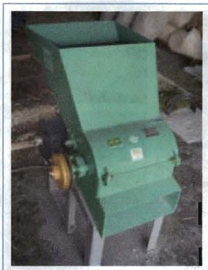
Figura 7. Máquina picadora de forraje.
