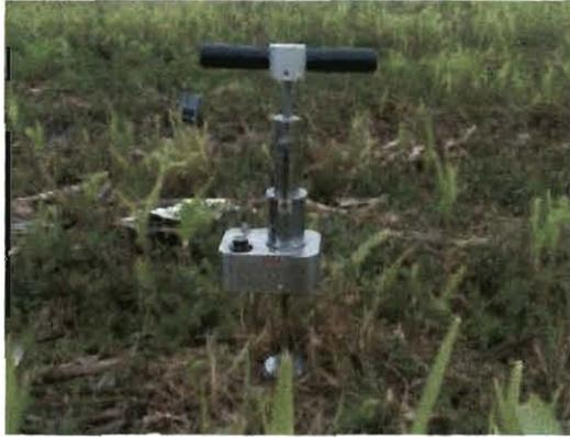
Figura 18. Penetrógrafo Daiki.
