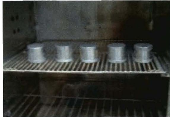
Figura 17. Muestras de densidad aparente en un horno.
