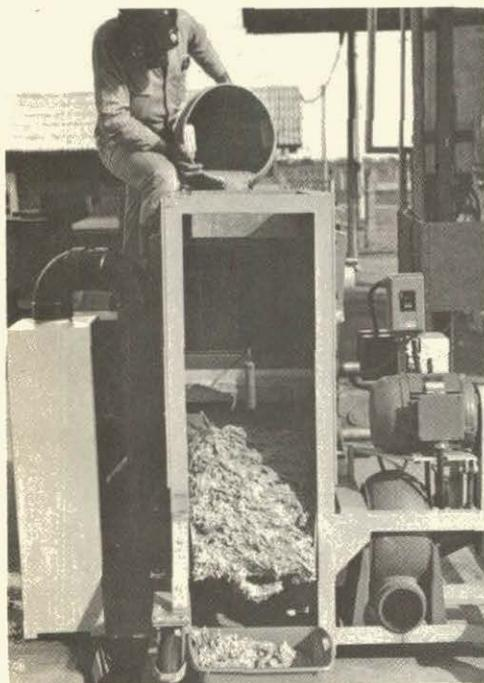
Figura 4. Extracción parcial del agua de la biomasa de proteína unicelular, utilizando una prensa de filtros construida en la Universidad de Guelph, Canadá.
