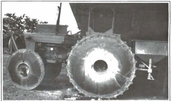
Figura 7. Tractor con rueda lenteja y sembradora.
