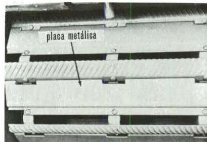
Figura 9. Esquema del cilindro con placas metálicas longitudinales para modificar la combinada de la Fig. 7.
