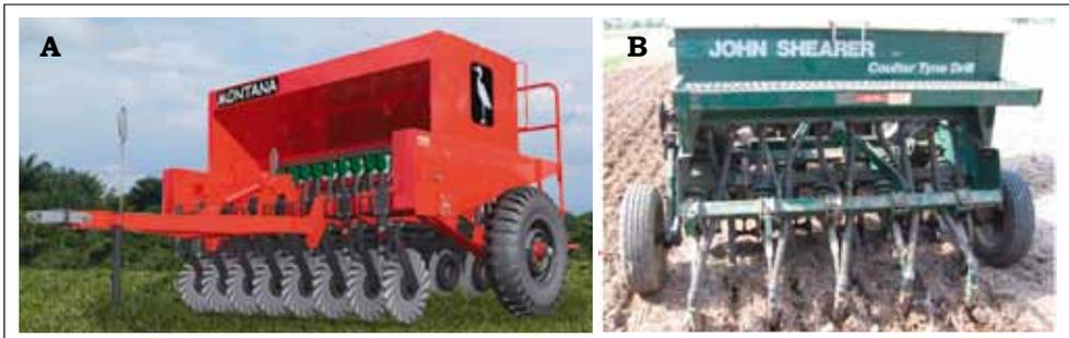
Figura 6. Dos tipos de sembradora: (A) de tolva y discos de corte; (B) de tolva y cindeles.
