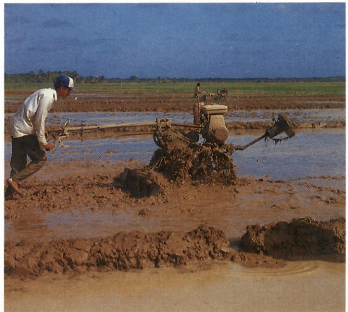
En República Dominicana se ha ensayado con éxito este pequeño motocultor diseñado por el IRRI, que aquí se utiliza para la nivelación adecuada del terreno.
