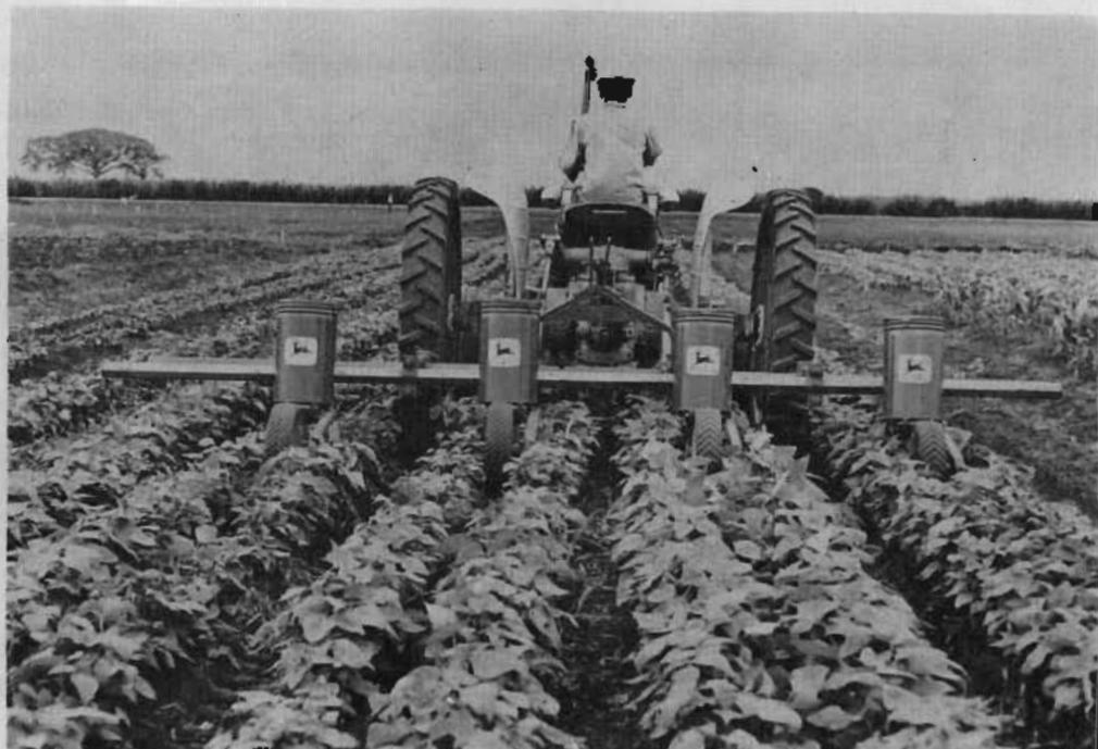
Siembra mecánica de maíz entre los surcos de frijol sembrado con el sistema de doble surco.
