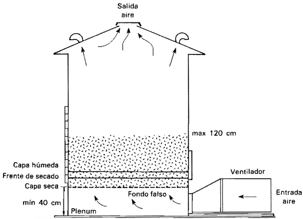
**Figura 6. Secador estacionario de fondo falso.**
