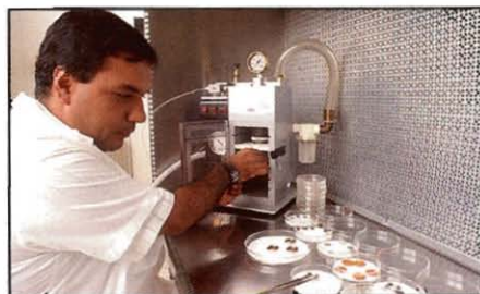
Figura 6. Los investigadores del CIAT están utilizando la biolística para transformar Brachiaria , frijol común y arroz. Esta tecnología contempla el uso de un acelerador de partículas PDS He/100 movido por helio, que bombardea los tejidos regenerativos con microproyectiles recubiertos de ADN.
