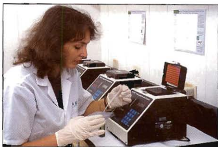
Figura 1. Un termociclador permite hacer millones de copias de ADN partiendo de una muestra pequeña del material mediante la metodología de PCR.
