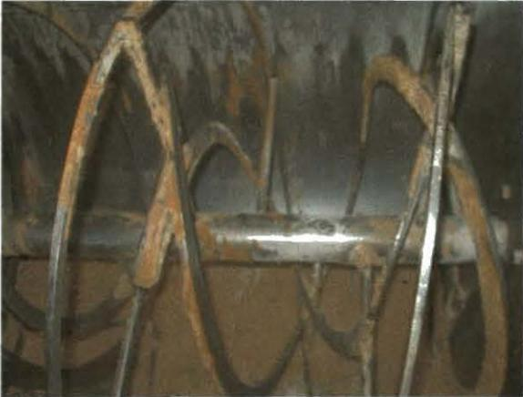
**Figura 22. Mezcladora horizontal con capacidad de 500Kg**
