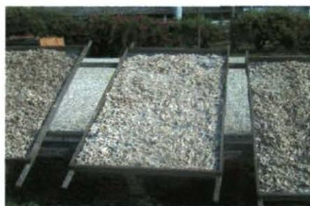
Figura 6. Secado en Bandejas
