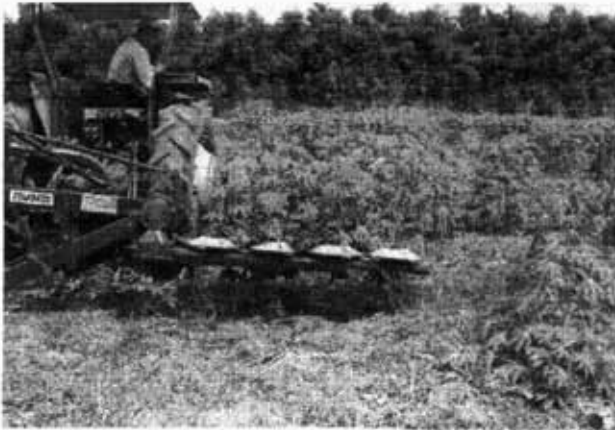
Figura 6.6.3. Cosecha mecanizada, cosechadora y picadora de una sola línea.
